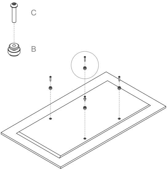
Montieren Sie auf der Rückseite des Bildschirms die Einhängebolzen (B) mittels der Schrauben (C) wie in der Abbildung oben dargestellt.
