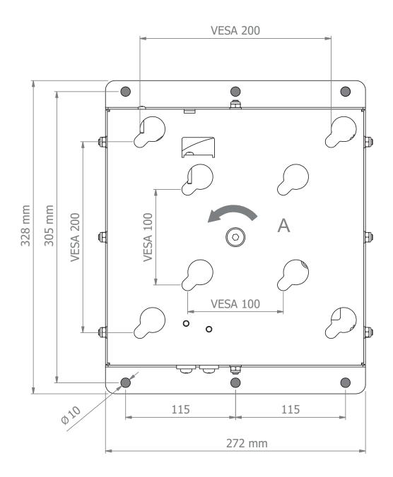
Montieren Sie die Halterung (A) an der Wand (siehe grau markierte Löcher) mit Montagematerialien, die für den Zweck und die Art der Wand geeignet sind. Prüfen Sie die Festigkeit der verwendeten Dübel und Schrauben.
